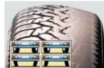
Las consecuencias de un mal reglaje de la geometría de los neumáticos
